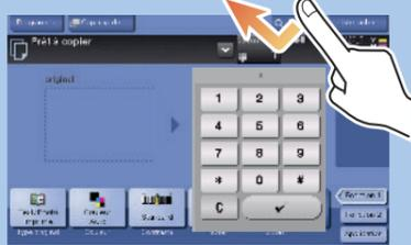
2. Si nécessaire, effleurez la partie supérieure du clavier et glissez-le vers une autre position d'affichage.
